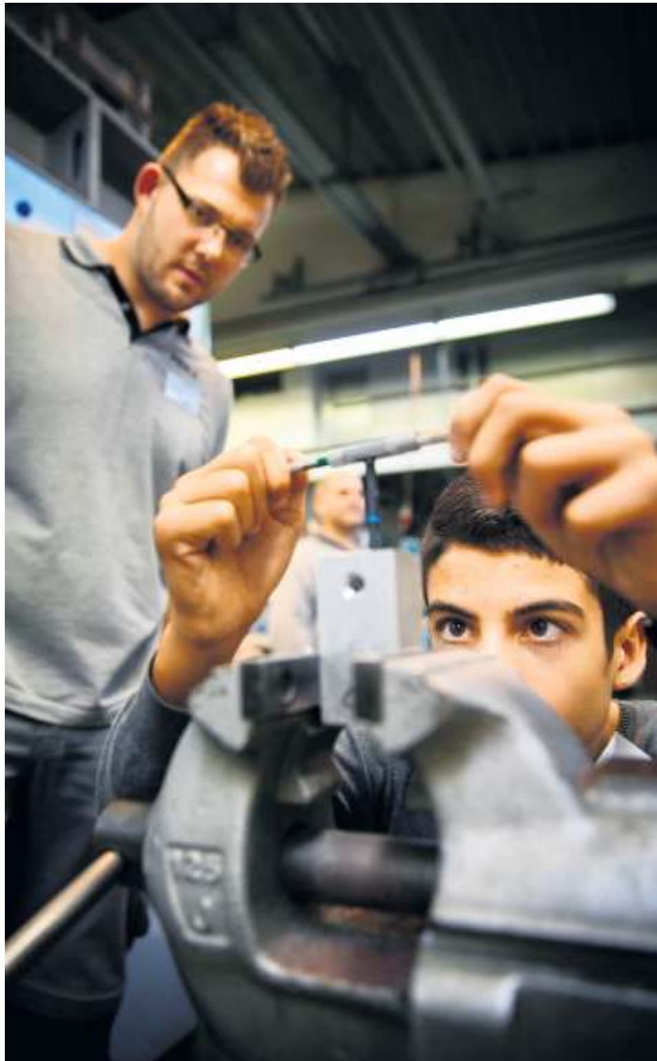
Der 13-jährige Praktikant Hassan Alci dreht unter der Anleitung des Ausbildungsleiters Thorsten Jäger ein Gewinde in ein Metallteil. Foto: Gottfried Stoppel
